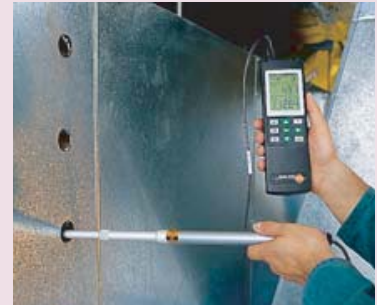
공조 시스템의 흡기, 배기상의 온도, 습도, 풍속, 풍량 측정
